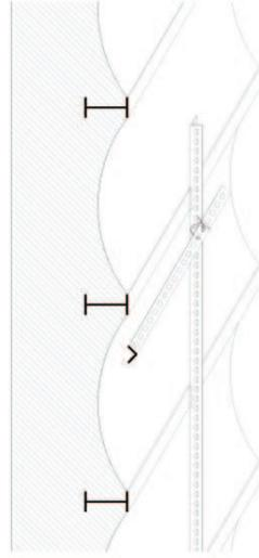
Estructura para cueque: dos perfiles soldados perpendicularmente a las viguetas del forjado. A éstos, y en perpendicular, atados otra serie de perfiles
