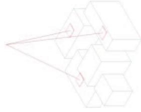
Núcleos verticales que funcionan por gravedad. Una cuerda que atraviesa en vertical una serie de cajas. Mediante una placa de policarbonato inserta en la última, el sistema queda equilibrado.
