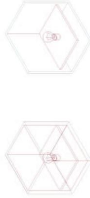
Núcleos compuestos por varias cajas unidas mediante cinta doble cara y de las cuales tres son estructurales. Mediante 3 puntos de sujeción se consigue la horizontal en el momento del cuelgue
